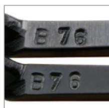
4. In beiden Scherenhälften befindet sich innen eine Identnummer (gleich für beide Seiten), sodass die jeweils passenden Teile wieder montiert werden können.
