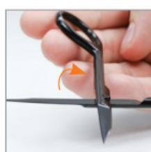
2. Heben Sie den oberen Teil der Schere an (ca. 45°) und lösen die beiden Scherenteile voneinander. Bei sachgemäßer Handhabung lassen sich die Scherenteile ohne großen Kraftaufwand korrekt lösen - ansonsten besteht die Gefahr einer Beschädigung / eines Bruches der Schraube.
