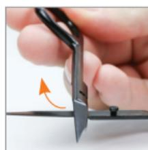
2. Eleve la parte superior de las tijeras (aprox. 45°) y separe las dos piezas. Si se manipulan debidamente, las dos piezas de las tijeras se pueden separar correctamente sin aplicar mucha fuerza; de lo contrario, existe el riesgo de dañar o romper el tornillo.
