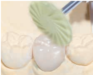
9771C* : Lustrage haute brillance des surfaces occlusales sans trop de pression, Vitesse de rotation recommandée: 7.000 –12.000 tr/min
