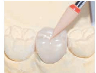
DCA10 : Lustrage de la forme externe sans besoin d'appliquer de pression, Vitesse de rotation recommandée : 7.000 – 12.000 tr/min
