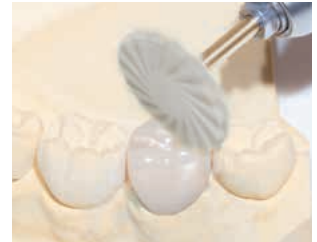
9769F* : Polissage de la couronne en haute brillance sans haute pression, vitesse de rotation recommandée : 3.000 – 8.000 tr/min
