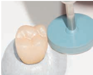
9736H : Retouche des points de contact, Vitesse de rotation recommandée : 8.000 – 12.000 tr/min
